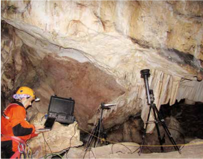
Figura 4. Equipo de monitorización microclimática, localizado en el entorno de un panel de arte rupestre. Sala de Columnas de Hércules, Galerías Altas
