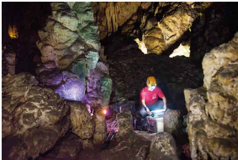
Figura 7. Zona de ensayo de luminarias específicas para reducir la tasa fotosintética de los biofilms fotosintéticos
