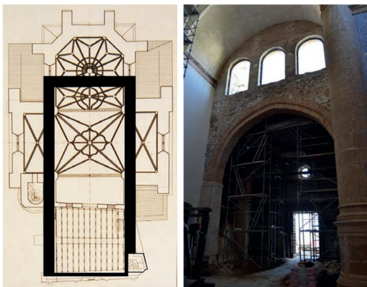
Figura 6 y 7. Imagen de la izquierda: Sobreposición de la planta de la Iglesia de Nuestra Señora de la Encarnación en sus fases mudéjar (negro) y gótica. Imagen de la derecha: Arco diafragma que vendrá a dar la solución de cierre en 1614 de manos de Pedro Díaz de Palacios
