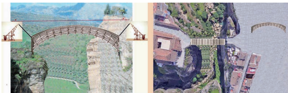
Figura 7. Vista lateral con la colocación de la cimbra por medio de grúas y una vista cenital de la cimbra ya colocada. Realizado por el autor. (La figura de la derecha se ha hecho a partir de Google Maps)
